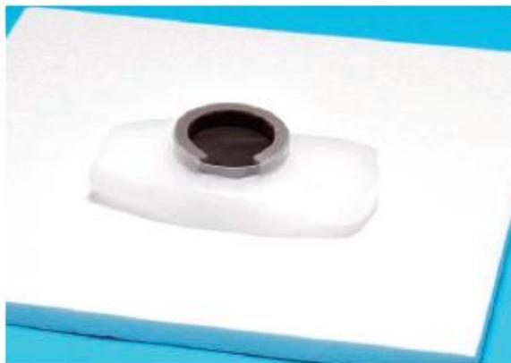
③放射線源の石を容器の底に置き、スポンジテープに、スポイトでエタノールをたっぷり染みこませます。(写真のように、石を置いた容器をドライアイスの上ののせてからエタノールを染みこませてもOKです。)そして、ふたをかぶせてドライアイスの上に置きます。ふたと容器の間に隙間があると、アルコールの蒸気が漏れてうまく飛跡が生じないことがあるので、確認しましょう。
