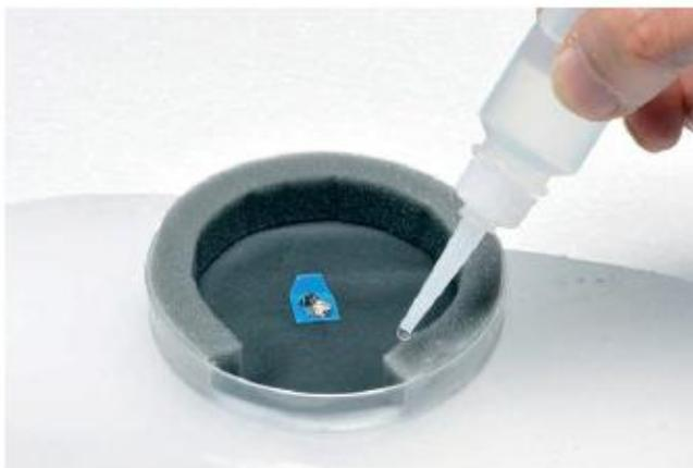
④プラスチックの容器の横の隙間から懐中電灯で照らします。塩ビパイプをキッチンペーパーでしっかりこすって静電気を起こし、蓋の上をすれすれに何度も左右に往復させ、容器内のイオンを取り除きます。しばらくすると、飛行機雲のような白い直線的な線が見えてきます。これはアルファ線が作ったイオンを核にしてアルコールの蒸気が集まってできたアルファ線の飛跡です。細かいジグザグの線が見えることもありますが、これはベータ線による飛跡です。放射線源の石がない場合でも、空気中のラドンや宇宙からの放射線(宇宙線)によってできる飛跡が見えることがあります。
