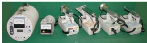
中性子用 電離箱型 GM計数管型  $\alpha$ 線用 I-125用 GM計数管型
